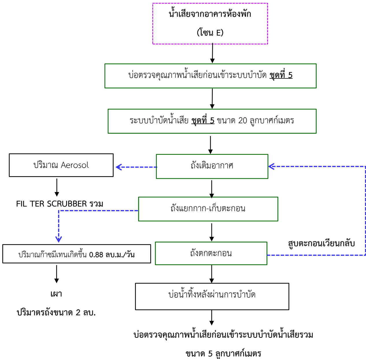
รูปที่ 5 ขั้นตอนการบำบัดน้ำเสียของระบบบำบัดน้ำเสียชนิดเติมอากาศเลี้ยงตะกอนเวียนกลับ (Aeration activated sludge process.,AS) ชุดที่ 5 ขนาด 20 ลูกบาศก์เมตร
